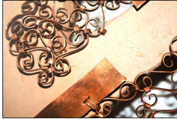
شكل (٢) ممارسات تجريبية للتشكيل بالشرائح المعدنية باستخدام أسلوب الحنى
